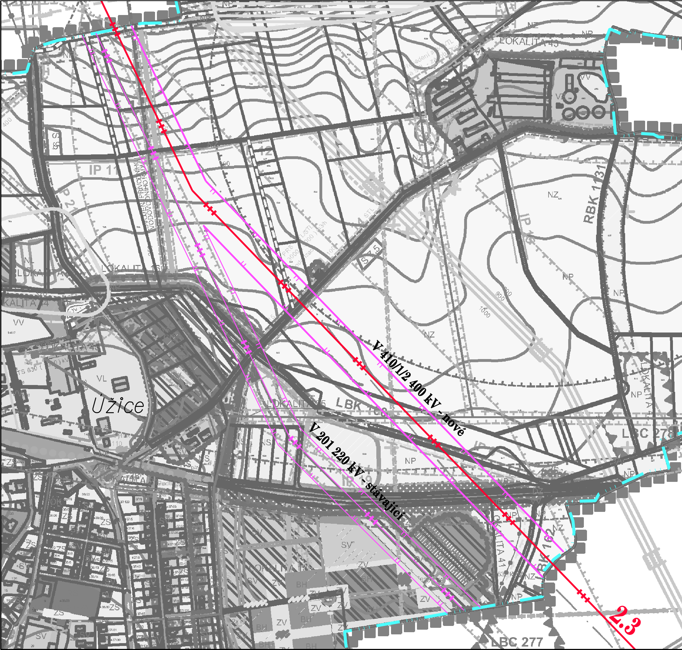
2.3 posílení stávajícího vedení VVN 400 kV (V410) novou trasou vedení 400 kV
